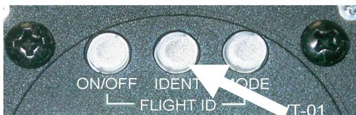
Falls Sie von der Flugverkehrskontrollstelle aufgefordert werden, die IDENT-Taste zu betätigen, drücken Sie bitte die mittlere Taste Ihres Transponders.
