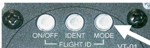
Der aktive Mode (im Beispiel ALT) wird in der Mitte der unteren Displayzeile angezeigt. Durch Drücken der Taste Mode können Sie zwischen folgenden Modi wechseln:
