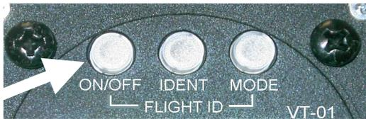
Durch kurzes Drücken auf den Ein-Aus-Schalter wird das Gerät eingeschaltet. Nach dem Einschalten zeigt das System die untenstehenden Informationen in der dargestellten Reihenfolge. Der Wechsel zwischen den einzelnen Bildschirmseiten erfolgt nach je ca. 3 sek. automatisch, kann aber auch durch Drücken einer beliebigen Taste manuell
